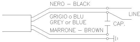
Figura 1: Schema di collegamento versione monofase Figure 1: Single-phase wiring diagram Figure 1: Schéma de connexion version monophasée Abbildung 1: Verbindungsschaltplan der einphasigen Version Figura 1: Esquema de conexión versión monofásica Figura 1: Esquema de ligação da versão monofásica Rysunek 1: Schemat podłączenia wersji jednofazowej
